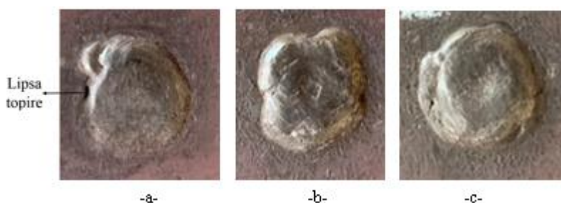
Figura 5.3 Aspectul macroscopic al depunerilor : a – cu 1 strat; b – 2 straturi; c – 3 straturi
